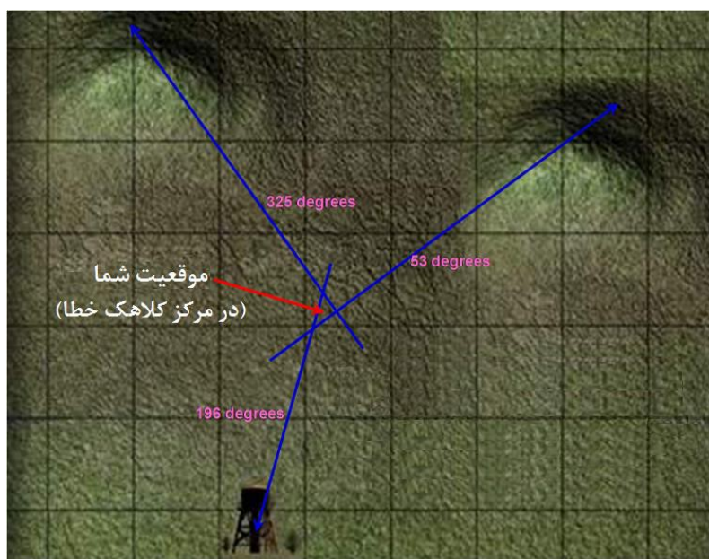
شکل ۴-۶: تعیین موقعیت بر روی نقشه به روش تلاقی سه گرا
