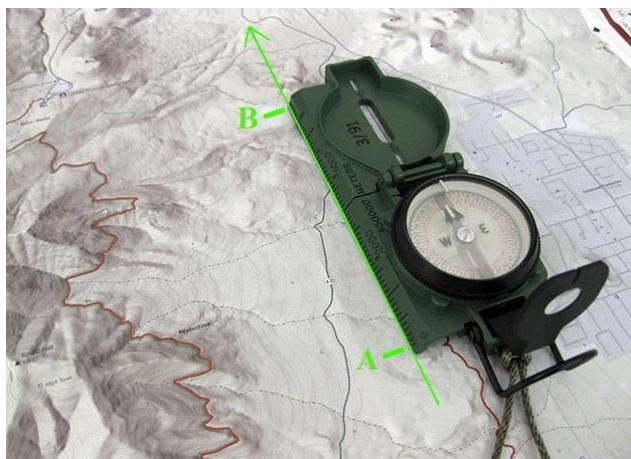
شکل ۲: اندازه‌گیری گرا بر روی نقشه با استفاده از قطب‌نمای نظامی
