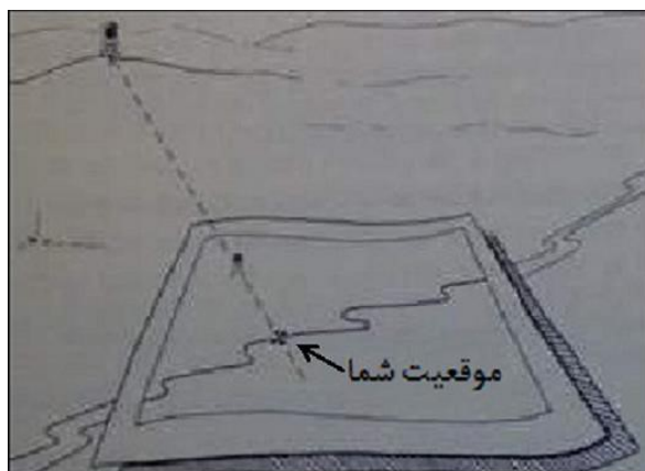
شکل ۴: تعیین موقعیت بر روی نقشه به روش تلاقی یک گرا و یک عارضه خطی
