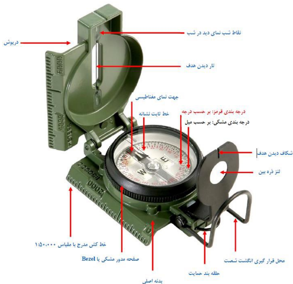
شکل ۴-۳: اجزای مختلف قطب‌نماهای نظامی
