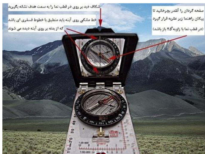
شکل ۴-۱۰: نحوه گراگیری با استفاده از قطب‌نمای شیشه‌ای
